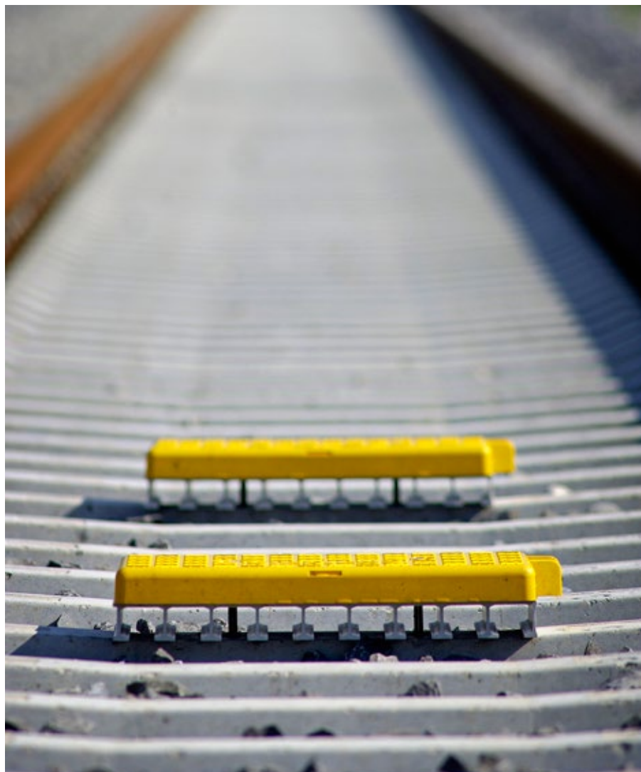
Eurobalisen sind gleisseitige Elemente des ERTMS.
