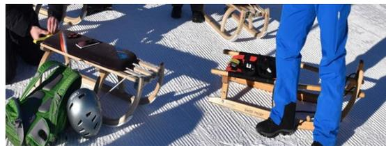
Die Schlitten wurden mit Beschleunigungssensoren (Xsens Dot, Xsens Technologies B.V, Niederlande) ausgestattet. Die Sensoren zeichnen die Beschleunigung in allen drei Raumrichtungen auf. Die Daten wurden mit einer Frequenz von 60 Hz aufgenommen. Die Sensoren wurden am hinteren Ende der Schlitten bzw. Rodel angebracht (Abbildung 2). Die Befestigung wurde zusätzlich durch Klebeband verstärkt, um zu verhindern, dass sich der Sensor vom Schlitten löst.
