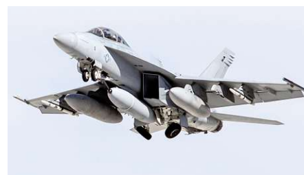
Super Hornet mit IRST-Block II-Behälter.
